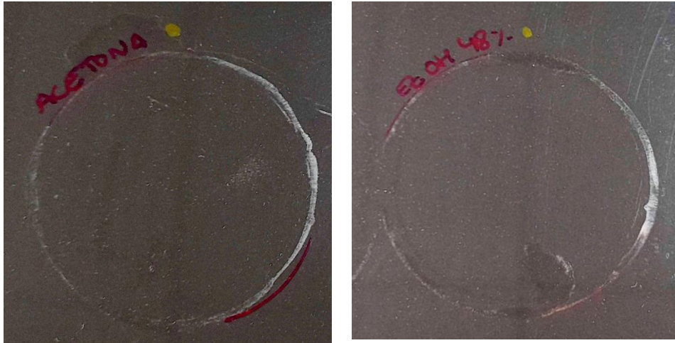
Imagen 2. Ataque químico de la acetona y el etanol 96%, tras 16 horas de contacto, en la muestra de polietileno lacado en negro. El mismo efecto se produce en la muestra de color blanco pero se disimula más.
