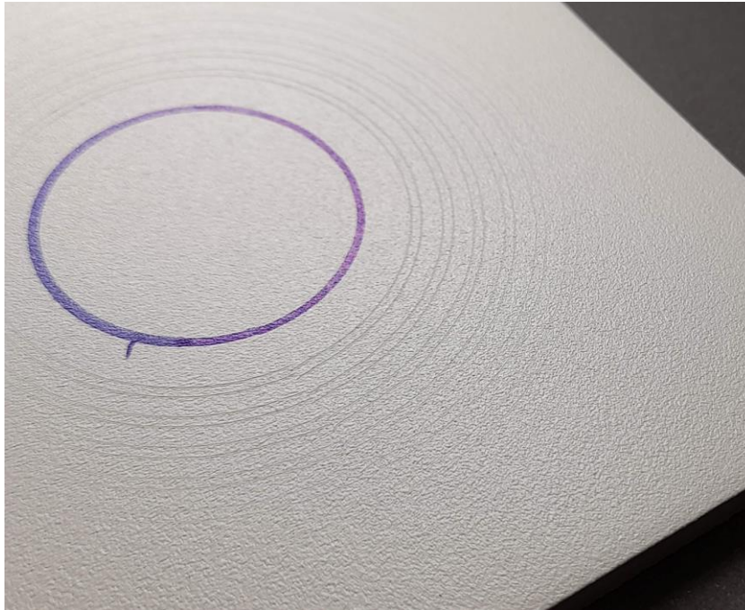
Imagen 5. Muestra aluminio lacado blanco. Rayado circular. Cargas aplicadas (N) crecientes de dentro hacia fuera: 5 -4,5 - 4 - 3,5 - 3 - 2,5 - 2 (N).
