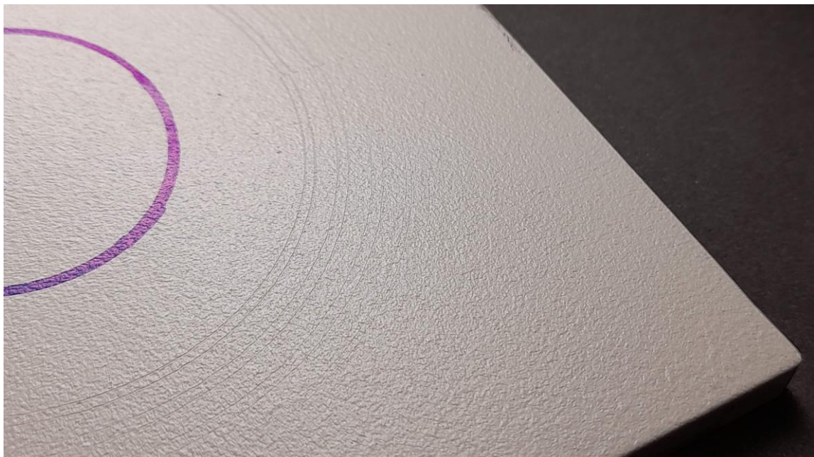
Imagen 8. Muestra inoxidable lacado blanco. Rayado circular. Cargas aplicadas (N) crecientes de dentro hacia fuera: 3,5 – 3 - 2,5 – 2 – 1,5 – 1 (N).
