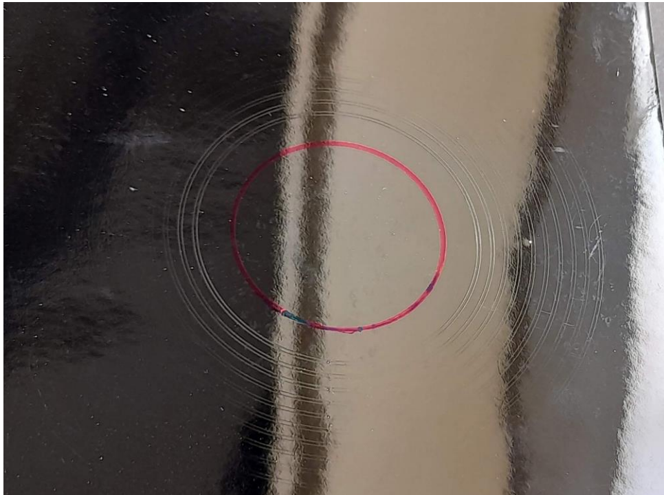
Imagen 7. Muestra polietileno lacado negro. Rayado circular. Cargas aplicadas (N) crecientes de dentro hacia fuera: 1,6 – 1,4 – 1,2 – 1 – 0,8 - 0,6 - 0,4 - 0,3 (N). El mismo efecto se observa en la muestra de polietileno y de propileno lacadas en blanco.
