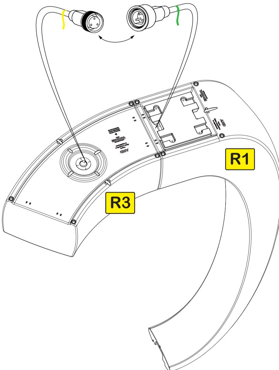
La conexión entre los modulos R2 y R3 se realizará del mismo modo, pero la hembra-amarillo estaria ubicada en la parte inferior de R2 y se conectaría al macho-verde del modulo R3.
