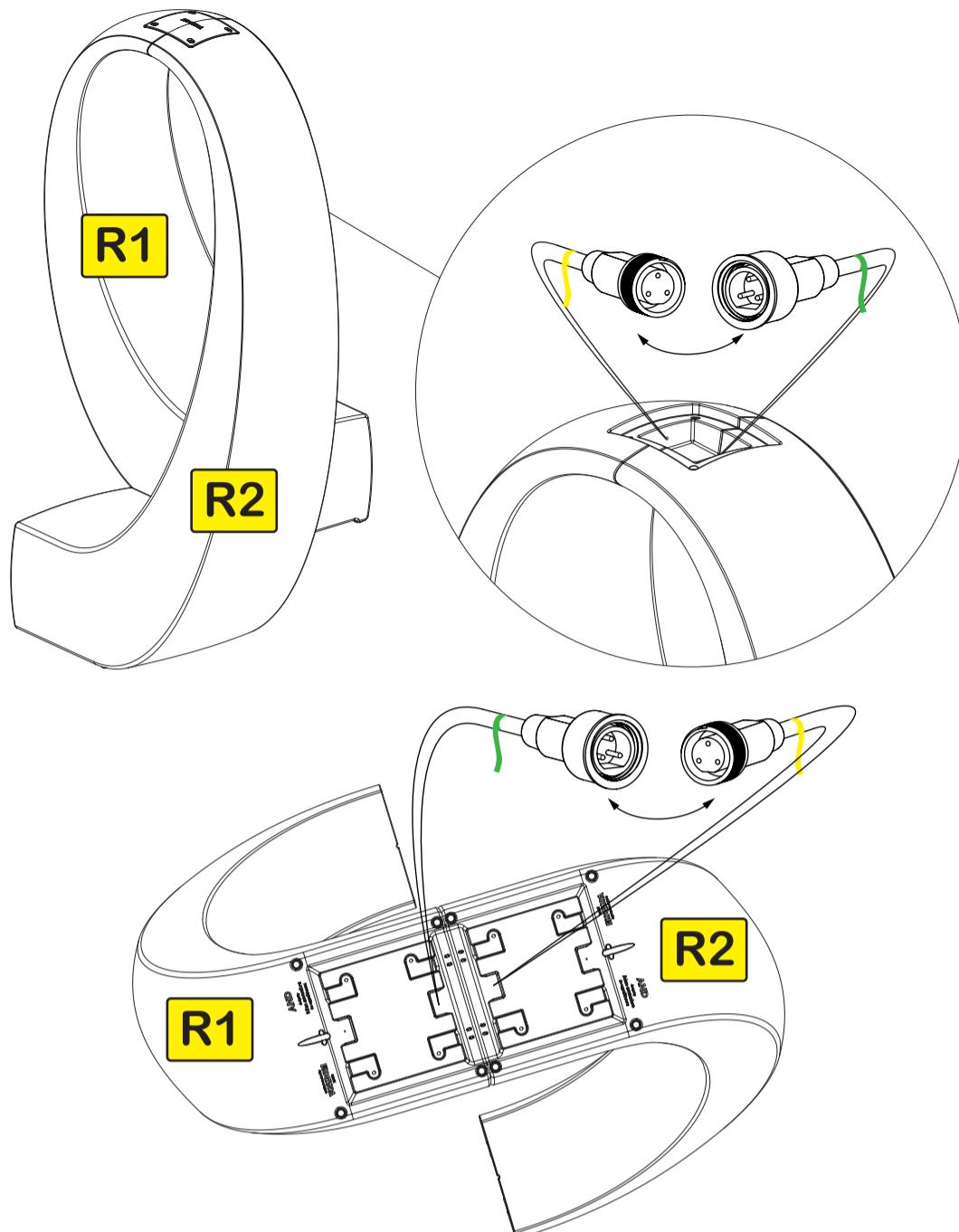
En la conexión inferior los cables estan ocultos dentro del contrapeso, saquenlos con cuidado.
