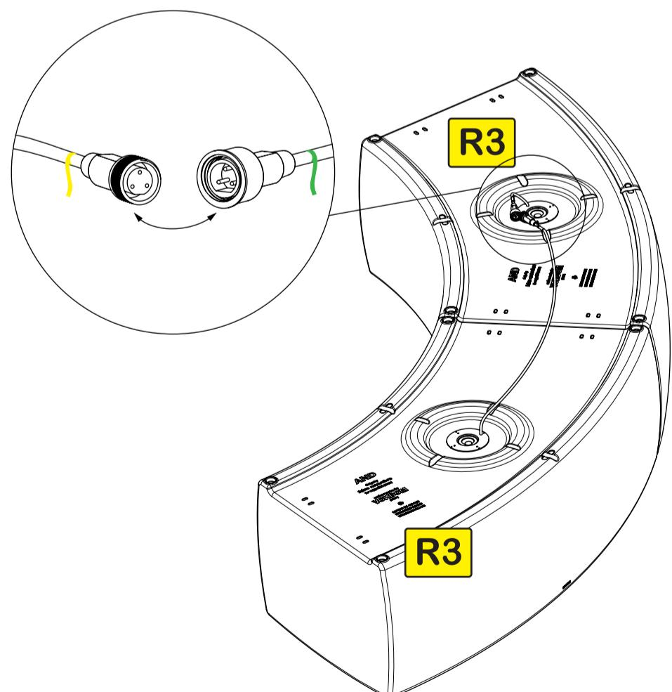
Todos los modulos R3 tienen un cable macho-verde y un cable hembra-amarillo, se pueden conectar entre ellos como se muestra en la imagen.
